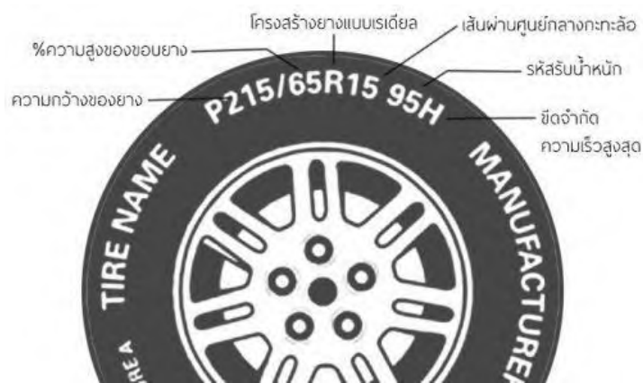
รูปที่ ๓.๕๐ ตัวอย่างความหมายและสัญลักษณ์บนแก้มยาง
