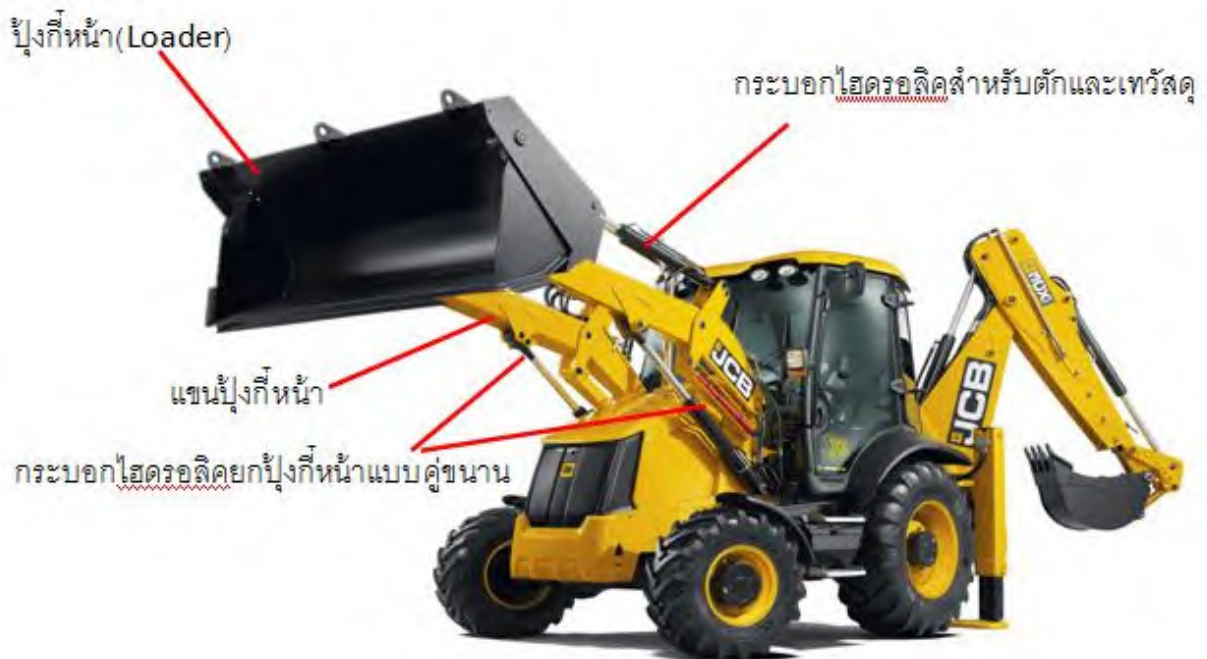
รูปที่ ๓-๘๑ ชุดปู้งกีตักดินด้านหน้า (Front End Loader)
