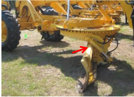
รูปที่ ๓-๑๐๓ การคว่ำหงายชุดไถมัดด้วยระบบไฮดรอลิค (ซ้าย) ด้วยระบบ Manual ใช้สลักขันล็อก (ขวา)
