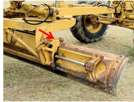
รูปที่ ๓-๑๐๓ การคว่ำหงายชุดไถมัดด้วยระบบไฮดรอลิค (ซ้าย) ด้วยระบบ Manual ใช้สลักขันล็อก (ขวา)
