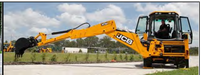
รูปที่ ๓-๙๓ อาร์มแบบพิเศษสามารถยืดออกหรือหดเข้าได้
