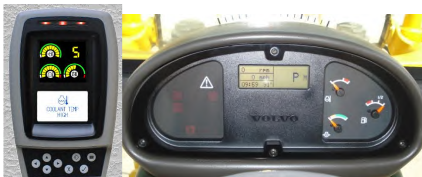
รูปที่ ๓.๒๗ มาตรวัดและสัญญาณเตือนจะรวมอยู่ในชุดแผงหน้าปัด
