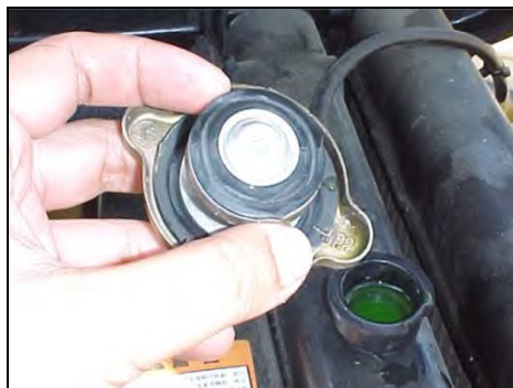
รูปที่ ๔-๑๒ การตรวจเช็คซีลฝาหม้อน้ำและระดับน้ำในหม้อน้ำ
