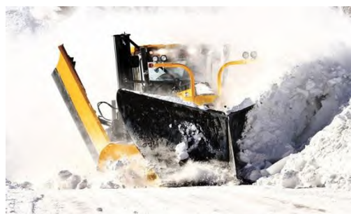
รูปที่ ๓-๑๑๑ ชุดเกลี่ยหิมะและการทำงาน
