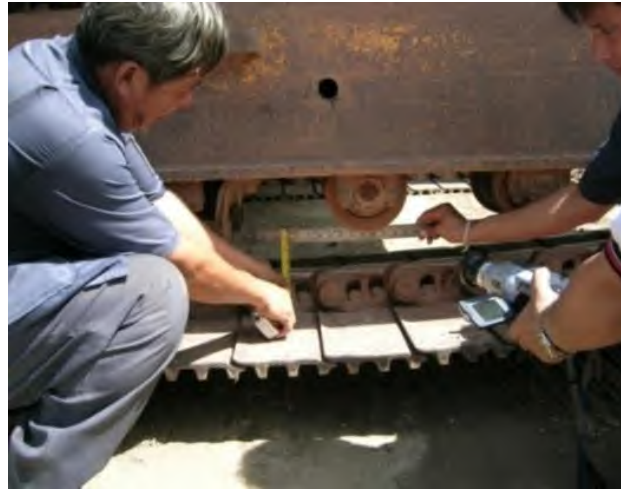
รูปที่ ๔-๕ การตรวจวัดความตึง หย่อนของโซ่ตีนตะขาบ
