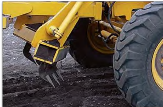
(ก) คราดขนาดเล็กที่ติดตั้งด้านหน้าของรถ (ข) คราดขนาดเล็กที่ติดตั้งด้านหน้าชุดใบมีด
