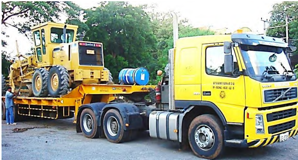
รูปที่ ๕-๒๒ การตรวจสอบความตึงของโซ่ผูกมัด
