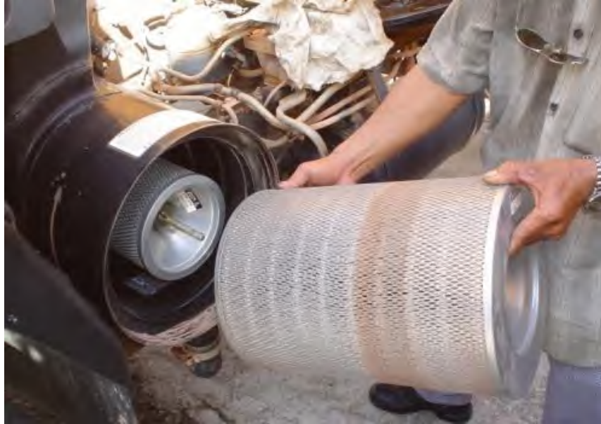
รูปที่ ๔-๒๔ การถอดและเป่าทำความสะอาดไส้กรองอากาศลูกนอก
