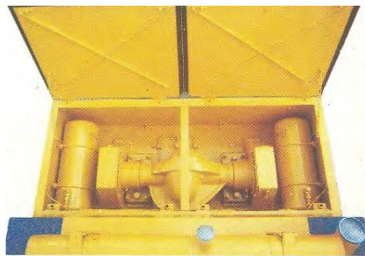
รูปที่ ๓-๑๒๘ แสดงการส่งถ่ายกำลังของเฟืองท้ายไปยังเพลาล้อผ่านโซ่
