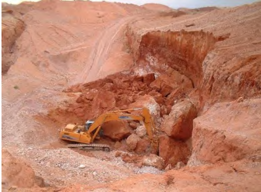
ก) ปฏิบัติงานใต้ไหล่เขา ที่เสี่ยงต่อการโคตถล่มทับ ข) ทำงานโดยไม่มีเครื่องกัน และสัญญาณเตือน รูปที่ ๕-๕ เครื่องจักรอยู่ในพื้นที่ไม่ปลอดภัย
