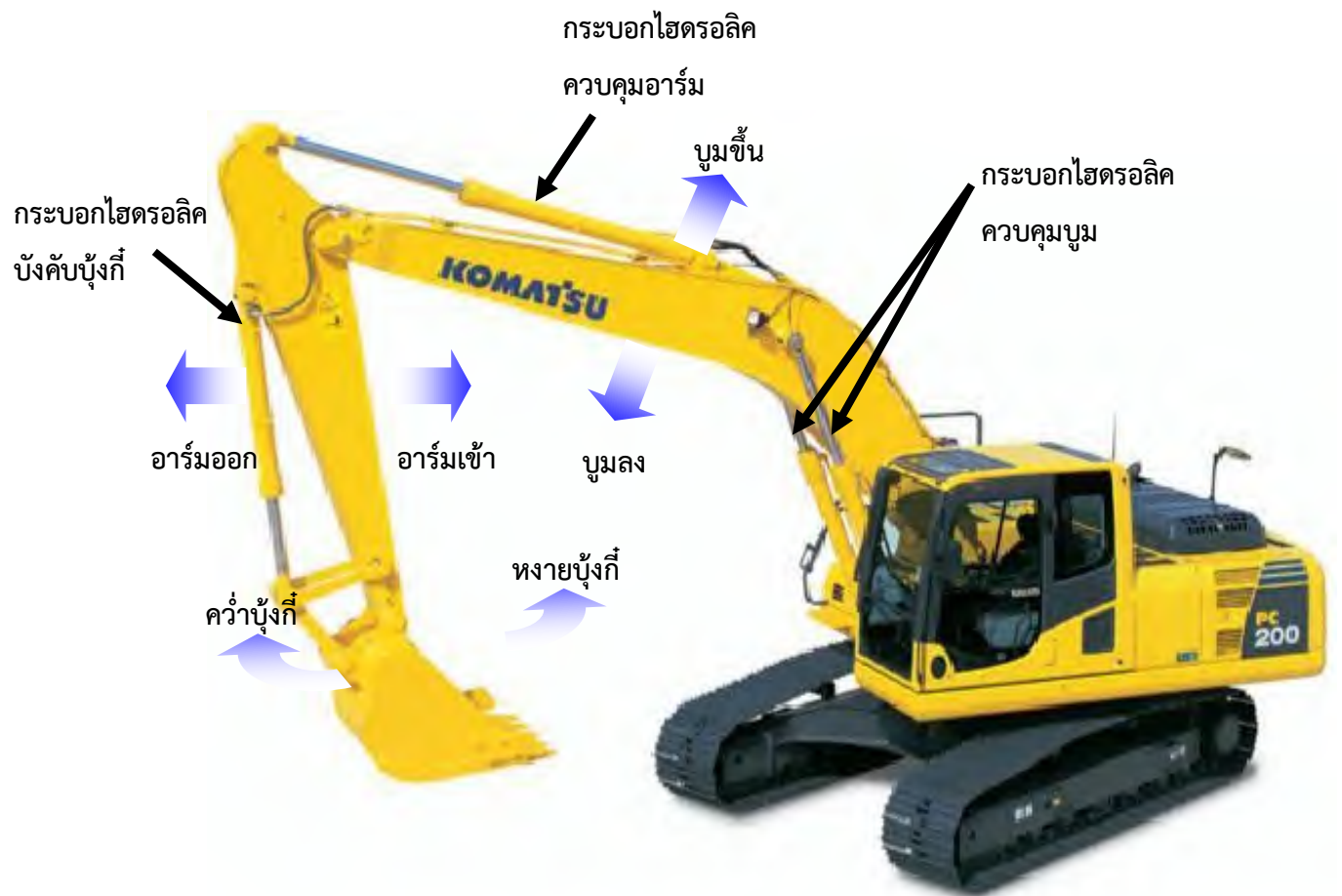
รูปที่ ๓-๕๙ รูปแบบการควบคุมคันบังคับแบบมาตรฐาน ISO
