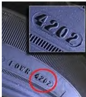
รูปที่ ๓.๕๑ ตัวอย่างสัญลักษณ์เป็นตัวเลขที่แก้มยาง
