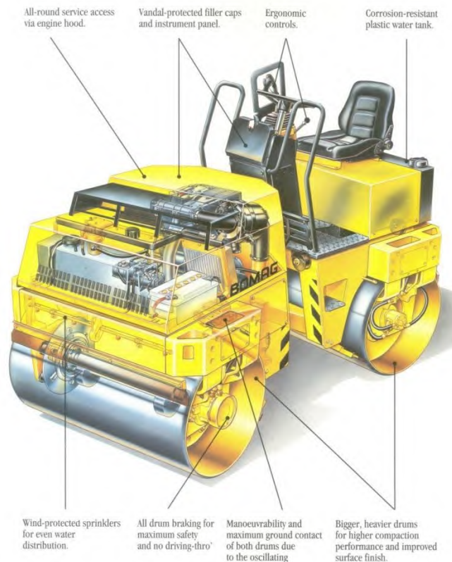
รูปที่ ๓-๑๓๓ โครงสร้างและส่วนประกอบต่างๆ ของรถบดสันสเทือน ชนิดล้อเหล็ก ๒ ล้อ
