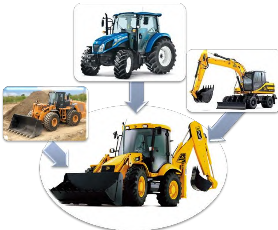
รูปที่ ๓-๖๗ แสดงองค์ประกอบพื้นฐานของรถดักหน้าชุดหลัง
