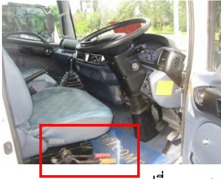
รูปที่ ๓-๑๑๔ แสดงคันโยกควบคุมการทำงานของดีเซล
