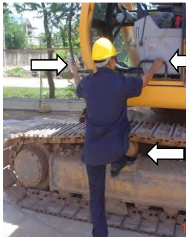
รูปที่ ๔-๑๗ การขึ้นและลงเครื่องจักรโดยวิธีการจับยึด ๓ จุด
