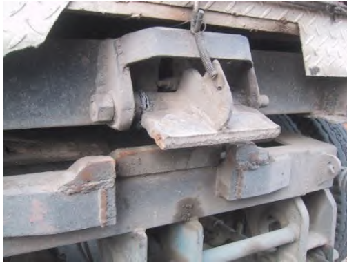
รูปที่ ๓-๑๑๙ สลักล็อกถอยหลัง (รูปซ้าย) สปริงปรับระดับแขนพวง (รูปขวา)
