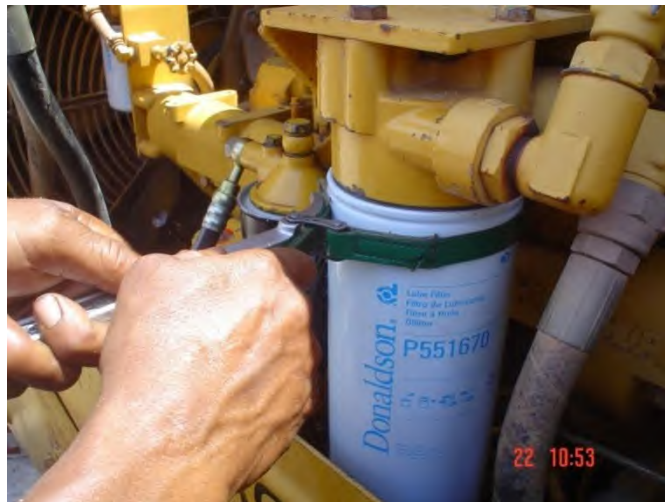
รูปที่ ๔-๒๐ การถอดกรองน้ำมันเครื่องด้วยประแจถอดกรอง
