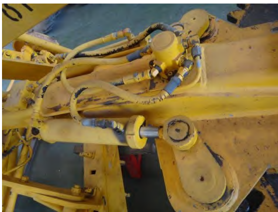
รูปที่ ๓-๑๐๗ การหมุนไถมีด ด้วยกระบอกไฮดรอลิก (ซ้าย) มอเตอร์ไฮดรอลิก (ขวา)
