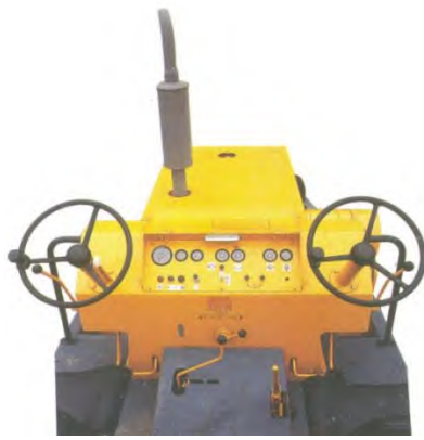
รูปที่ ๓-๑๓๐ แสดงการการบังคับเลี้ยวโดยใช้กระบอกลิควดดันลิคว
