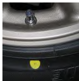
รูปที่ ๓.๕๒ จุดสีเหลืองบนแก้มยาง (weight mark)
