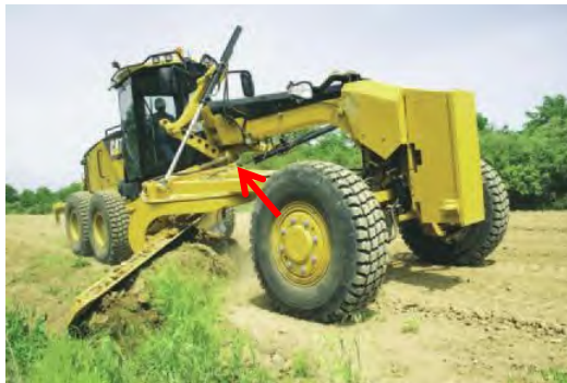
รูปที่ ๓-๑๐๖ การเลื่อนไถมีดและชุดวงเดือออกด้านข้างเพื่อปาดไหล่ทาง
