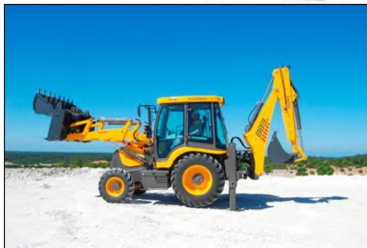
รูปที่ ๓-๘๒ ปู้งกีแบบพิเศษ win๑ เปิดส่วนที่ใช้ตักออกทำให้สามารถใช้งานแบบไบนารีแทรกเตอร์ดินตะขাপได้
