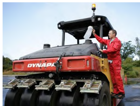
รูปที่ ๓-๑๓๒ การเติมน้ำหรือถูทรายในการเพิ่มน้ำหนักตัวรถ
