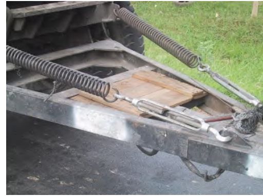
รูปที่ ๓-๑๑๙ สลักล็อกถอยหลัง (รูปซ้าย) สปริงปรับระดับแขนพวง (รูปขวา)
