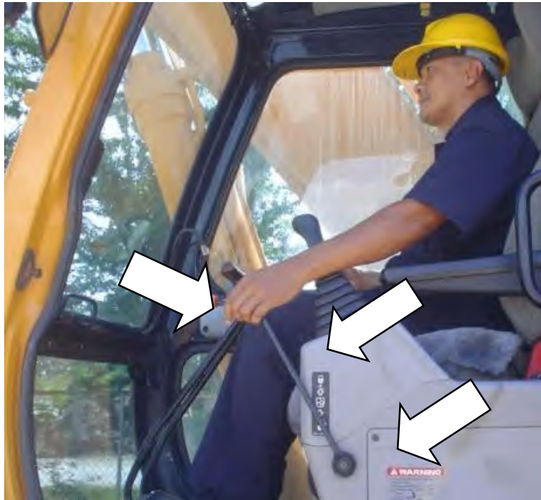
รูปที่ ๔-๑๙ ตำแหน่งคันบังคับควบคุมอยู่ในตำแหน่งว่างและคันล้อยึดไฮดรอลิกอยู่ในตำแหน่งล้อยึด
