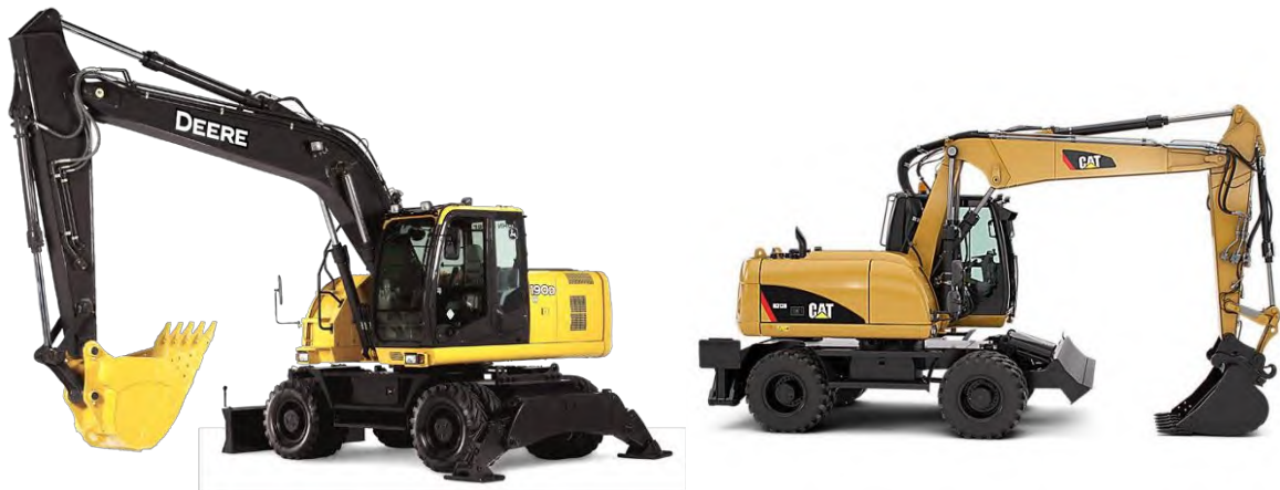
รูปที่ ๓-๖๑ รถขุดตัวอย่างแบบบูมขึ้นเดียว (รูปซ้าย) และแบบบูม ๒ ขึ้น(รูปขวา)
