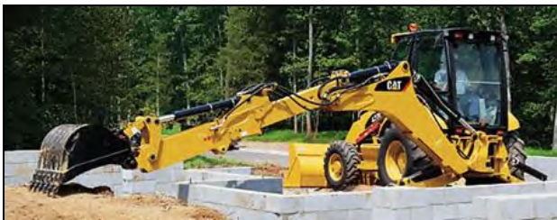
รูปที่ ๓-๙๓ อาร์มแบบพิเศษสามารถยืดออกหรือหดเข้าได้
