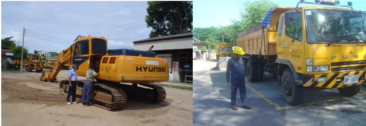
รูปที่ ๔-๓ การตรวจสอบเช็คสภาพความพร้อมก่อนใช้งานเครื่องจักร
