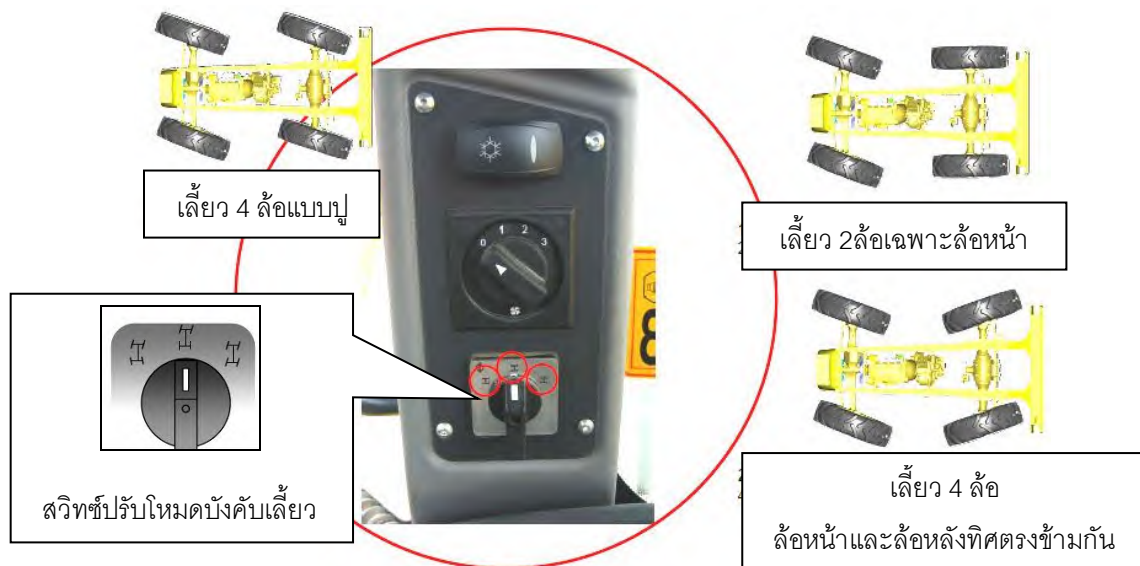
รูปที่ ๓-๗๗ แสดงการควบคุมระบบบังคับเลี้ยวแบบ ๔ ล้อ (Full power hydrostatic system)
