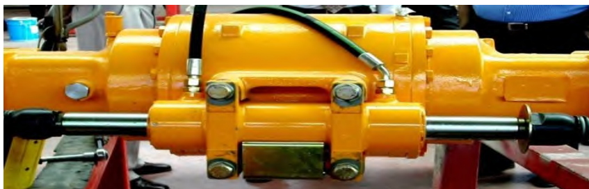
รูปที่ ๓-๗๘ กระบอกไฮดรอลิคบังคับเลี้ยวติดกับชุดเพลาชับ
