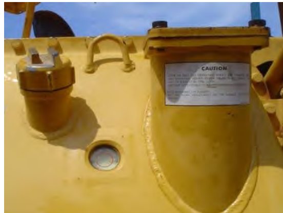
รูปที่ ๔-๒๓ ลักษณะหลอดแก้ววัดระดับน้ำมันไฮดรอลิกของรถแทรกเตอร์ดินตะขบ
