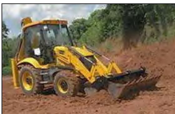
รูปที่ ๓-๘๕ ใช้เป็นใบมีดดันวัสดุแบบรถแทรกเตอร์ดินตะขาบ (Dozer)
