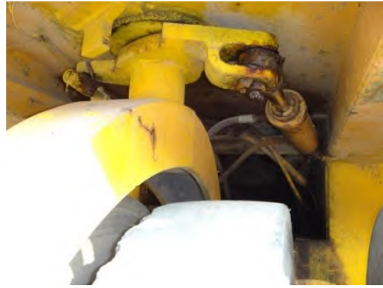
รูปที่ ๓-๑๓๐ แสดงการการบังคับเลี้ยวโดยใช้กระบอกลิควดดันลิคว
