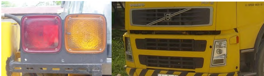
รูปที่ ๓.๒๖ ชุดไฟท้ายและชุดไฟหน้าซึ่งจะรวมไฟแสงสว่างและไฟสัญญาณไว้ด้วยกัน
