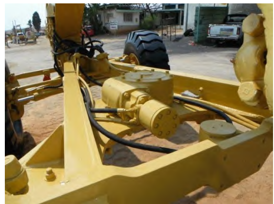
รูปที่ ๓-๑๐๗ การหมุนไถมีด ด้วยกระบอกไฮดรอลิก (ซ้าย) มอเตอร์ไฮดรอลิก (ขวา)
