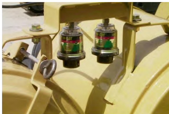
รูปที่ ๔-๑๔ ตัวบอกสภาพของกรองอากาศ
