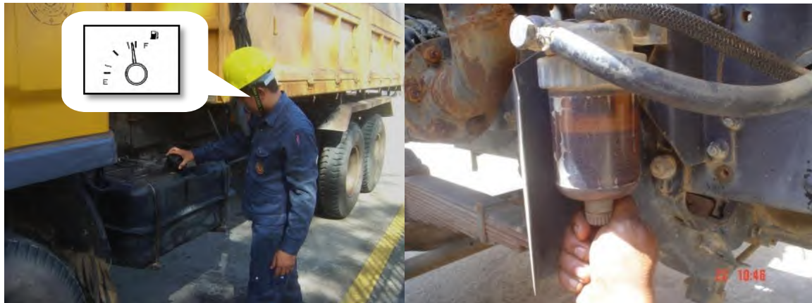
รูปที่ ๔-๘ การตรวจเช็คน้ำมันเชื้อเพลิงและถ่ายน้ำมันออกจากกรองดักน้ำ
