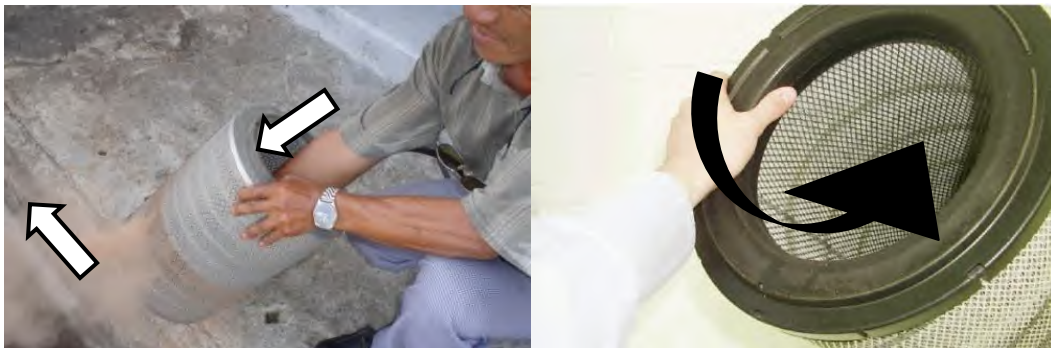
รูปที่ ๔-๒๕ การเป่าทำความสะอาดไส้กรองอากาศโดยใช้ลมเป่าจากด้านในออกมาด้านนอก
