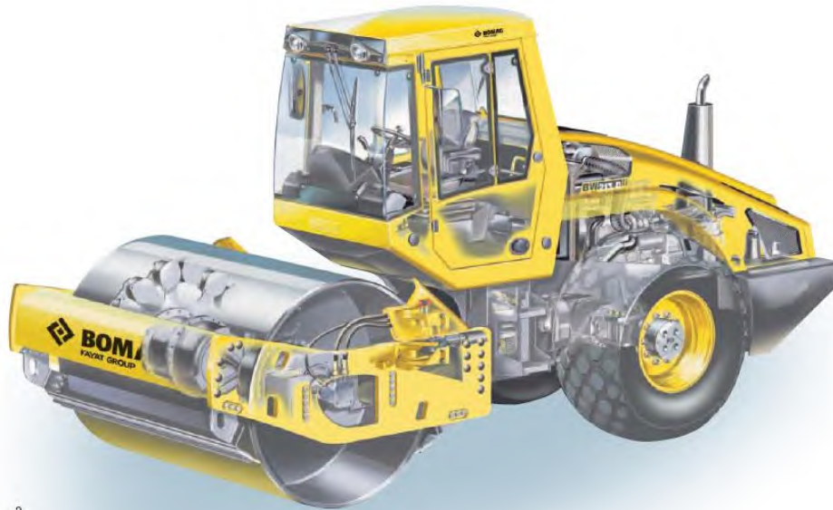
รูปที่ ๓-๑๓๔ โครงสร้างและส่วนประกอบต่างๆ ของรถบดสันสะเทือน ชนิดล้อเหล็กเดี่ยว
