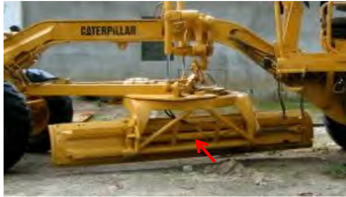
รูปที่ ๓-๑๐๕ แสดงกระบอกไฮดรอลิกเลื่อนไถมีดออกด้านข้าง
