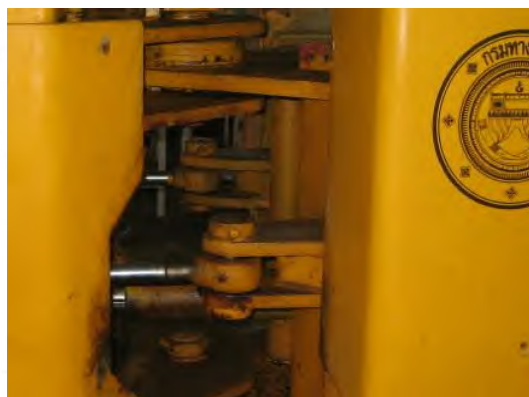
รูปที่ ๓.๓๓ การหักเลี้ยวโดยใช้กระบอกไฮดรอลิคหักกลางลำตัวในภาพขวาจะเห็นจุดหมุนที่ทำงานเหมือนบานพับ
